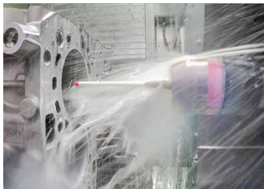
ZDJĘCIE 2: ROZWIĄZANIA BLUM UMOŻLIWIĄJĄ UZYSKANIE DOKŁADNYCH I WIARYGODNYCH WYNIKÓW POMIARÓW ZA POMOCĄ SOND DOTYKOWYCH SERII TC, NAWET W PRZYPADKU STOSOWANIA CHŁODZIWI.
