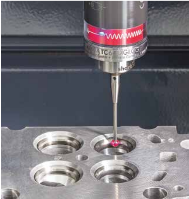
ZDJĘCIE 3: SONDA DOTYKOWA TC64-DIGILOG POZWALA NA SKANOWANIE ANALOGOWE, A TYM SAMYM MONITOROWANIE FAZKI USZCZELNIAJĄCEJ W GNIEZDZIE ZAWORU W CZASIE, GDY DETAL JEST NADAL ZACIŚNIĘTY.
