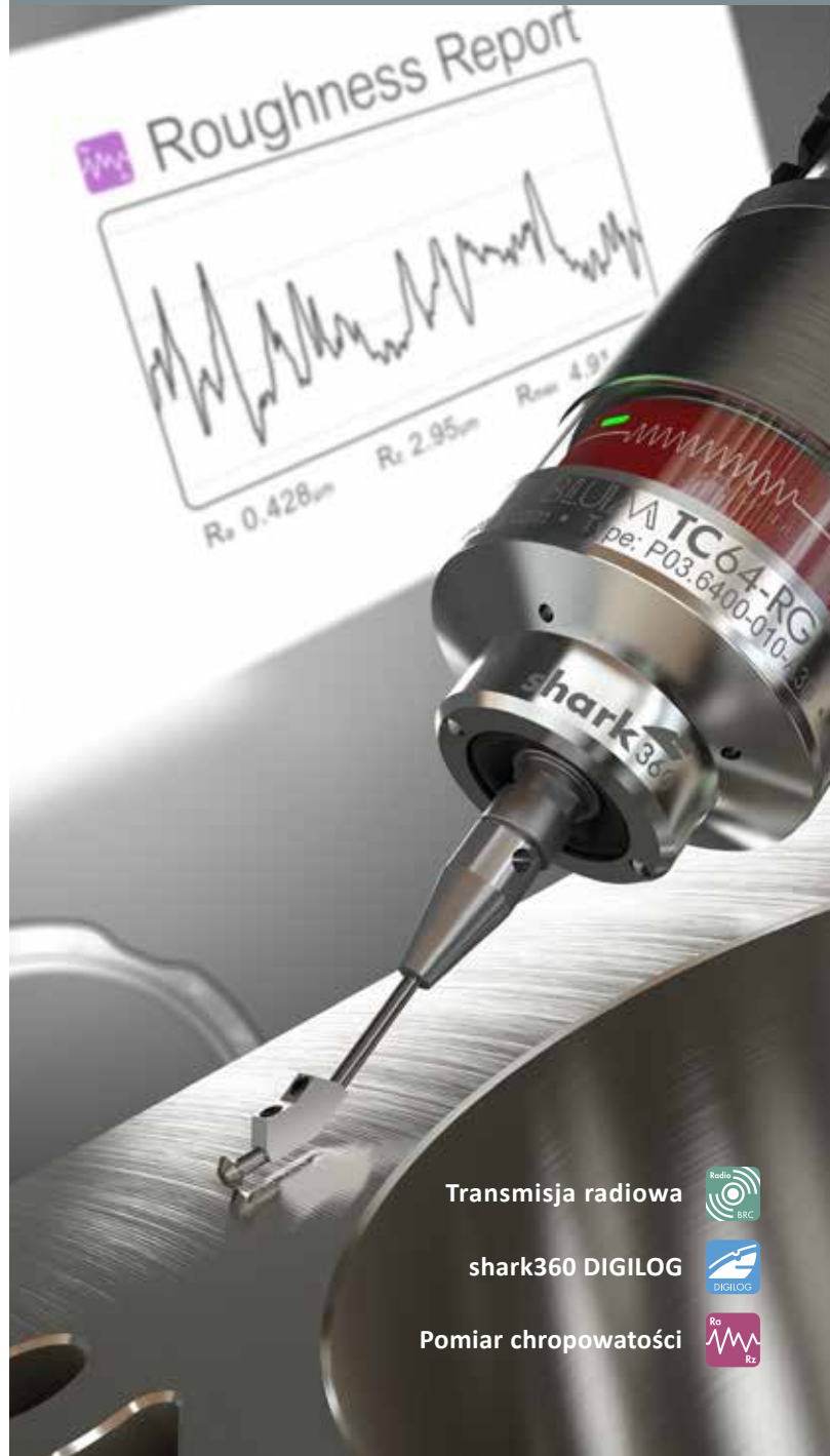
ZDJĘCIE 3: SONDA DOTYKOWA TC64-DIGILOG POZWALA NA SKANOWANIE ANALOGOWE, A TYM SAMYM MONITOROWANIE FAZKI USZCZELNIAJĄCEJ W GNIEZDZIE ZAWORU W CZASIE, GDY DETAL JEST NADAL ZACIŚNIĘTY.
