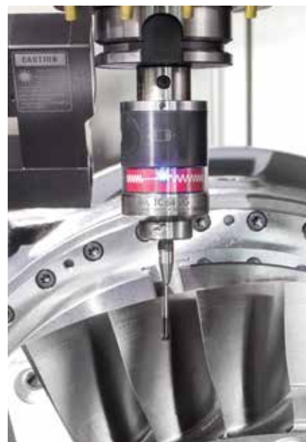
ZDJĘCIE 1: SZYBKI POMIAR CHROPOWATOŚCI ŁOPAT WIRNIKA ZA POMOCĄ NOWEJ SONDY DO POMIARU CHROPOWATOŚCI TC64-RG.
