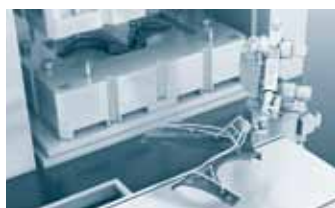
Pewne chwytanie i przenoszenie wytłaczanych części.
