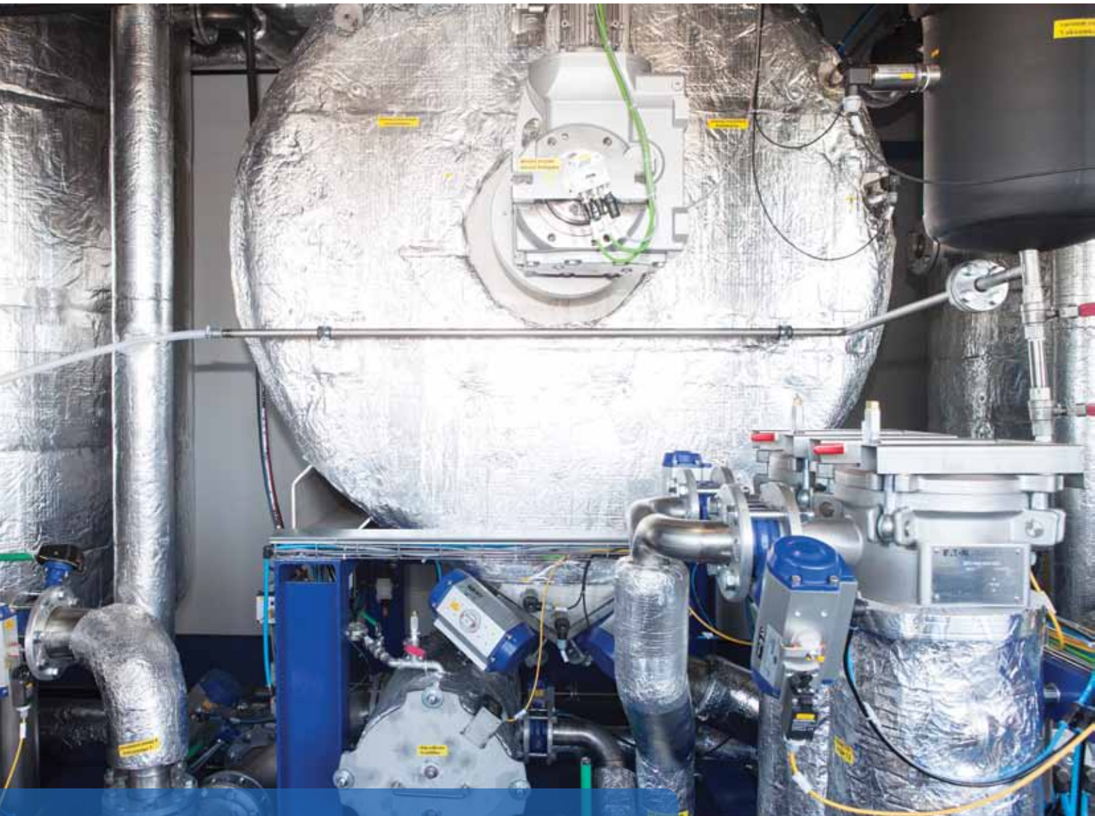
Wnętrze odtuszczarki z widoczną komorą myjącą oraz jednym z dwóch zbiorników (tutaj PER)
