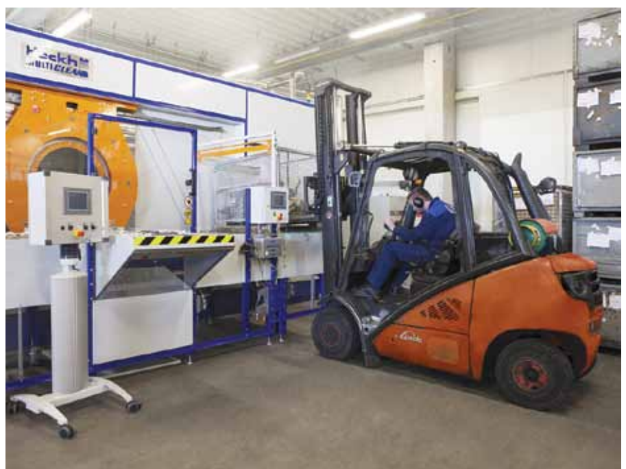
Odtłuszcarka typu Multiclean z węglowodorowym (PER) medium odtłuszcającym
