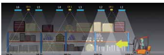
Rys.5 Naruszenie pierwszej czujki powoduje rozświetlenie opraw z pierwszej strefy do poziomu ustawionego na zadajniku (80%), pozostałe oprawy są przygaszone do minimum (10%), moc zasilania ok. 120 W
