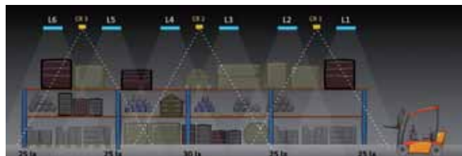
Rys.4 W układzie z czujnikami ruchu i zadajnikiem ustawionym na 10% (brak ruchu w alejce), moc zasilania ok. 40 W
