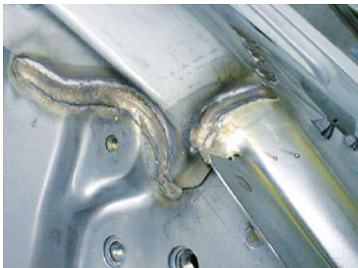
Rys. 8. Lutospawane elementy karoserii samochodowych
