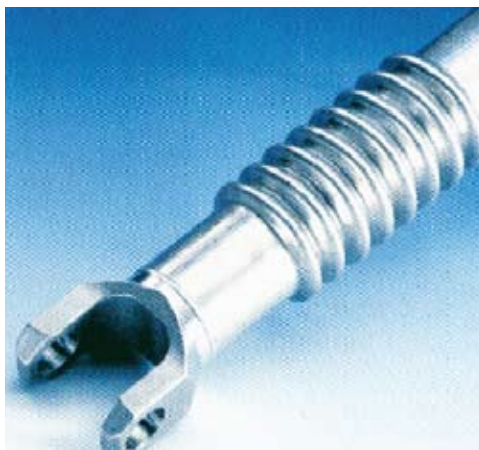
Rys. 2. Elementy o symetrii obrotowej układów napędowych spawane laserem
