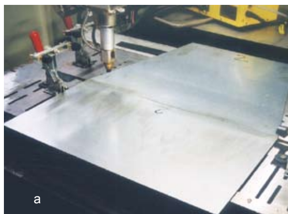
Rys. 5. Wykroje typu tailored blanks spawane w Instytucie Spawalnictwa a) pospawane części składowe wsadu do tłoczenia b) wytłoczka po przemysłowych testach tłoczenia c) wytłoczka po przemysłowych testach wykrawania
