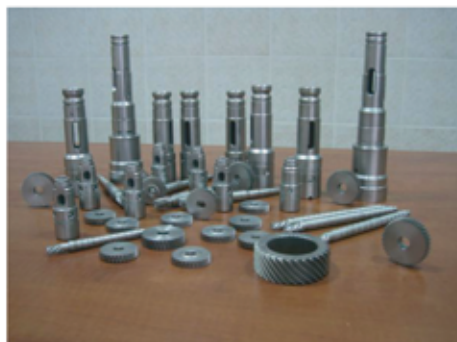
Rys. 4 Czystość detali po nawęglaniu próżniowym realizowanym w Bodycote Polska
