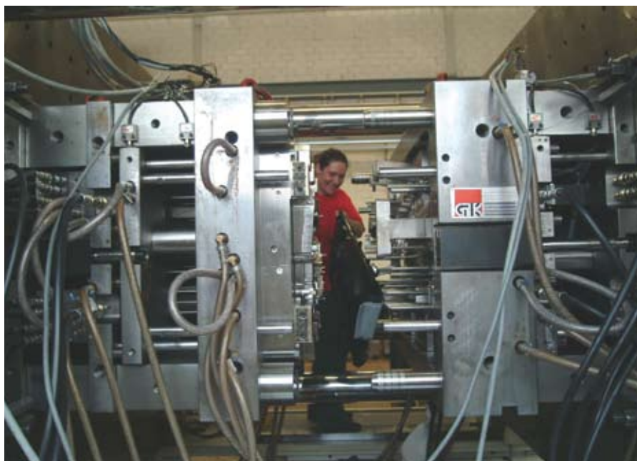
ina wtryskowa z systemem GK Synventive do wtrysku tworzywa na materiale
