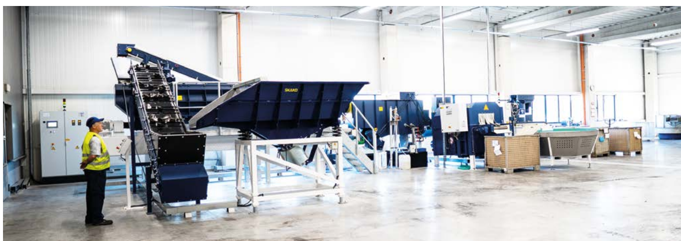
PRZELOTOWA MASZYNA DO OBRÓBKI WIBROŚCIERNEJ. URZĄDZENIE W PEŁNI ZAUTOMATYZOWANE.
