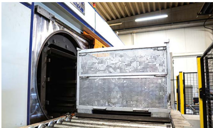
PER-ODŁUSZCZARKA. KOSZE MYJĄCE 1200*800*800. MAX.ZAŁADUNEK 1200KG.
